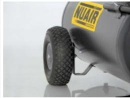
Compresor de piston con motor de gasolina, supervisado por HONDA. Montados sobre deposito de 10+10 litros. Ruedas neumaticas para facilitar el transporte. Barras adicionales facilitan los procedimientos de elevacion.
